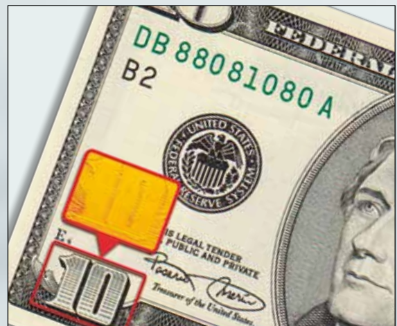
Visualisierung von magnetischen Sicherheitsmerkmalen bei Geldscheinen
