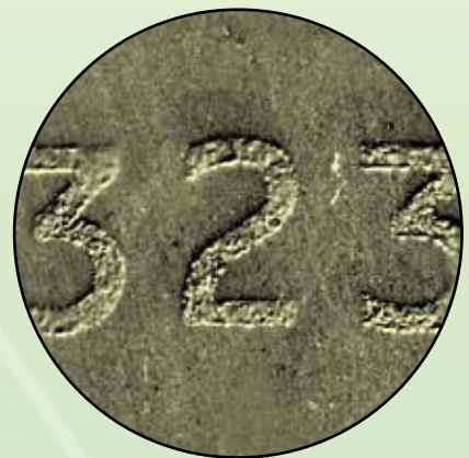
Visualisierung der magnetischen Struktur einer Seriennummer
