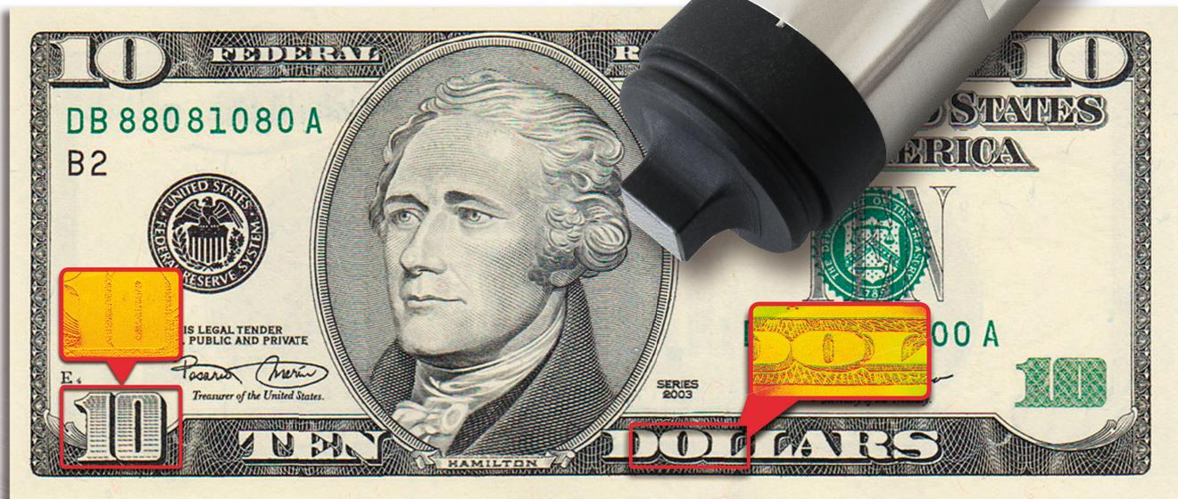
Abbildung: Kontrolle von magnetischen Sicherheitsmerkmalen bei Banknoten
