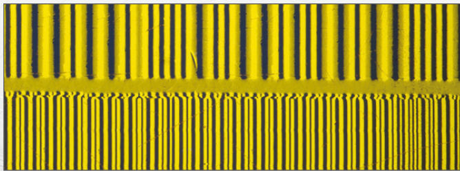
Abbildungen: Visualisierung der magnetischen Struktur von Linearencodern
