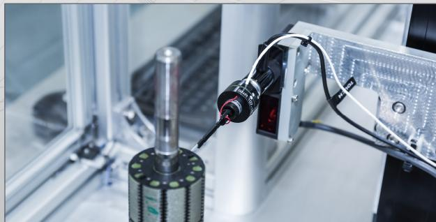
Demgegenüber wird das tatsächliche Magnetfeld erheblich von der Qualität der verwendeten Magnete beeinflusst. Beim RMP werden Hallsensoren (ein- und 3-achsig) eingesetzt, um das Magnetfeld präzise zu vermessen. Die Rotor-Spannfutter können schnell und einfach ausgetauscht werden. Damit ist es möglich, unterschiedlichen Anforderungen bei den Vermessungen der Rotoren gerecht zu werden (Dimension, Rundlaufegenschaften, nicht-magnetische Aufnahme etc.).
